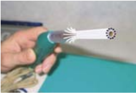
© L. MENARD Prototypé de caméra (sonde TRIOP sensible aux particules \beta^+ ) pour guider la chirurgie des tumeurs cérébrales
