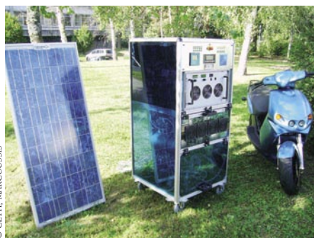
Figure 4 : L'hydrogène, vecteur d'énergie pour les applications de transport. Les capteurs photovoltaïques (gauche) produisent de l'électricité à partir du rayonnement solaire. Cette électricité sert à produire de l'hydrogène par électrolyse de l'eau dans un électrolyseur (centre). Le véhicule (scooter, droite) fait le plein d'hydrogène. Il s'agit d'un véhicule électrique. La motricité est assurée par une pile à combustible et un moteur électrique.
